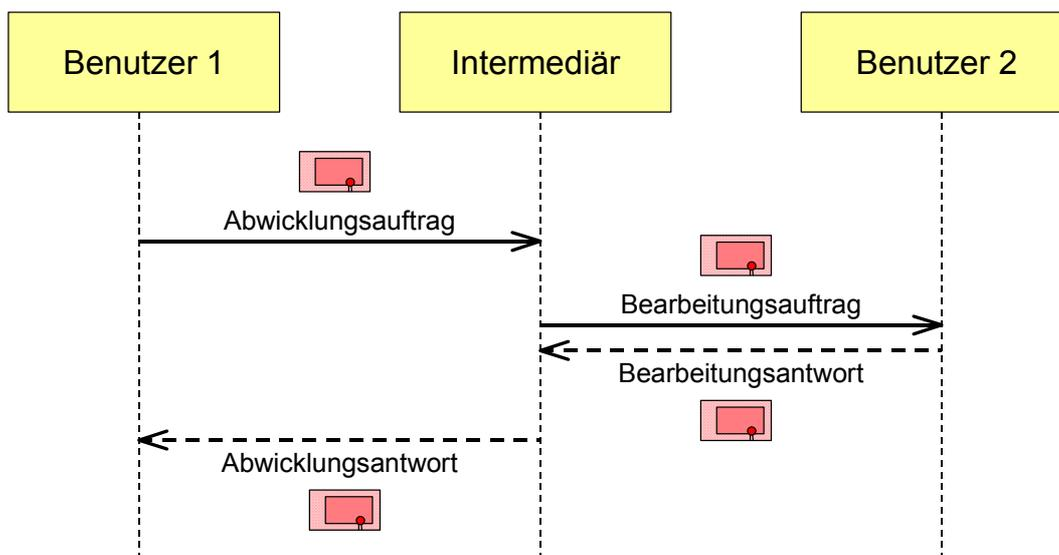
Abbildung 6: Request-Response, passiver Empfänger
