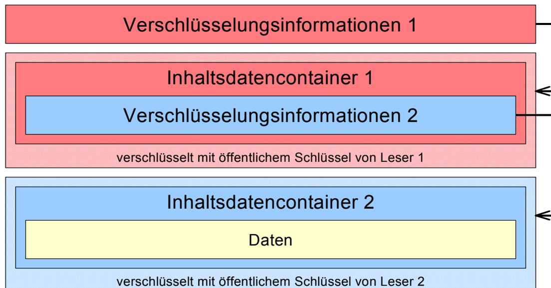
**Abbildung 2: Mögliche Realisierung des Vier-Augen-Prinzips**
