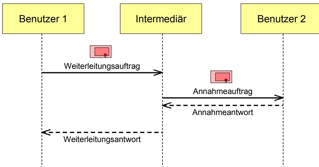
Abbildung 5: One-Way-Message, passiver Empfänger
