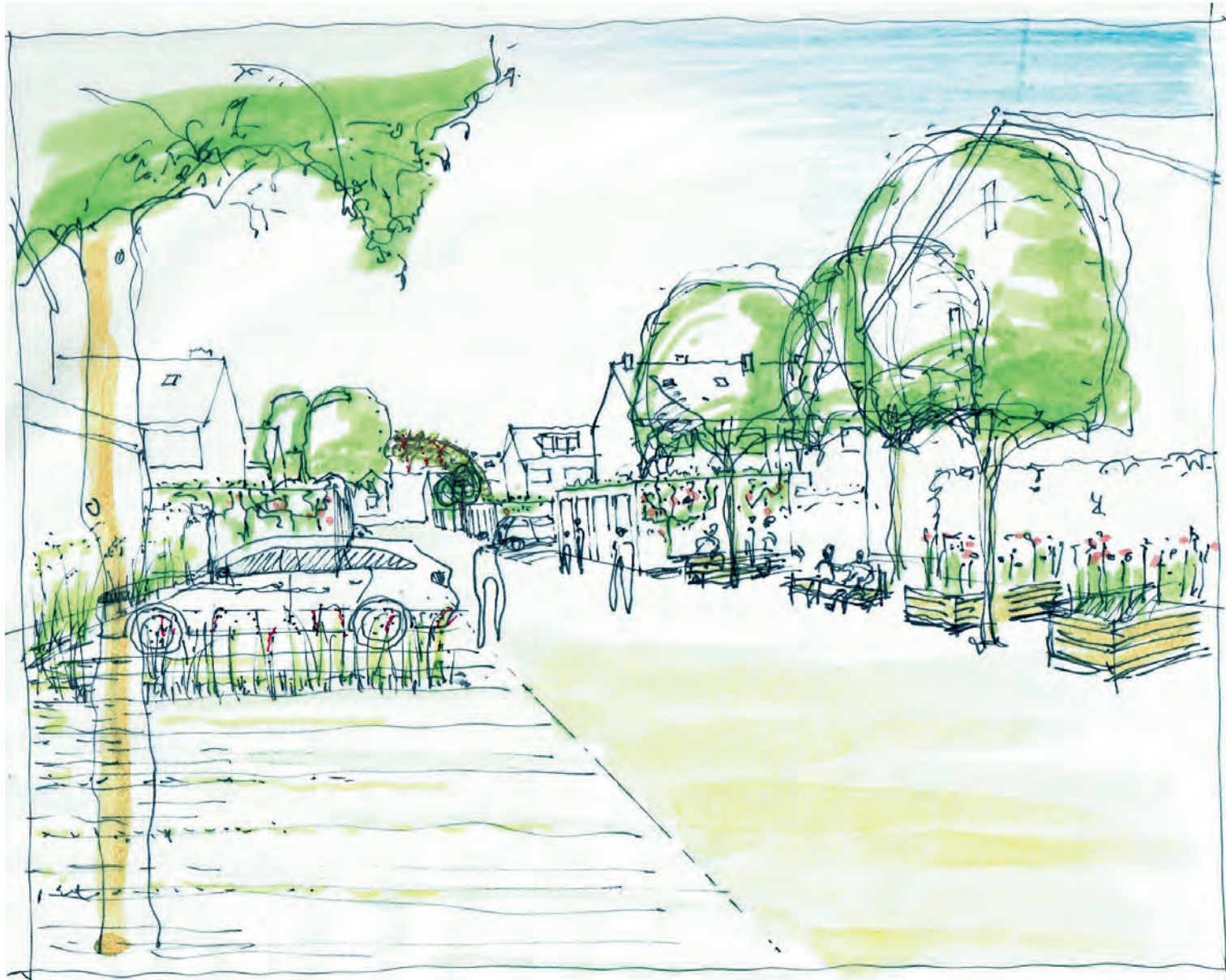
Rasenfugen als sickerfähiger Belag, naturnahe Parkplatzgestaltung
