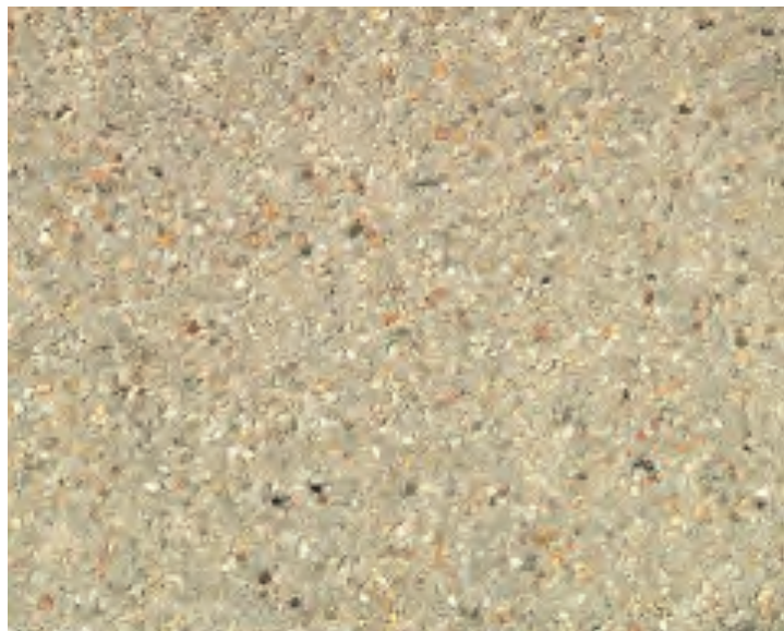
Dränasphalt mit sandfarbenem Zuschlagstoff
