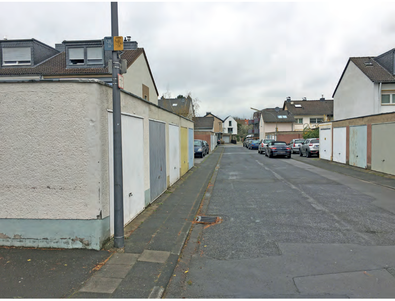
Gehwege sind zu schmal, uneben und eingeengt durch Laternen, keine Barrierefreiheit.
