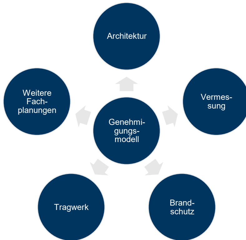
Abbildung 13: Struktur der Fachbereiche/-Modelle für den BIM-basierten Bauantrag
