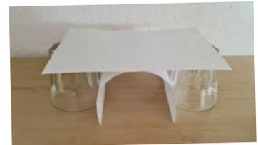
**Für die dritte Brücke** schneidest du mehrere gleich breite Papierstreifen aus und klebst sie zu einem langen Streifen zusammen. Du unterteilst ihn dann in gleich breite Abschnitte. Dann faltest du jeweils zwei Abschnitte nach innen und zwei nach außen. Jetzt klebst du noch die Bänder mit Klebestreifen zusammen und fertig ist eine Balkenbrücke.
