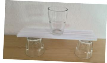
**Die zweite Brücke** besteht aus zwei Blättern. Du legst eines davon auf zwei Kartons und testest, wie stabil sie ist. Nimm danach das zweite Blatt und bilde daraus einen Bogen unterhalb des ersten Blattes – jetzt teste noch einmal, wie stabil die Konstruktion nun ist.
